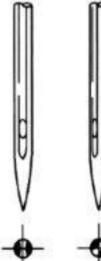
Внимательно проверьте иглу, чтобы скошенная кромка была обращена в сторону задней части машины.
