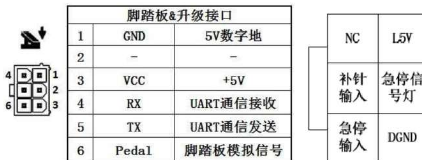
Рисунок 1-2-2. Соответствие разъемов блока управления
