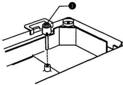
2. Вставить две петли (2) в отверстия в платформе машины.
