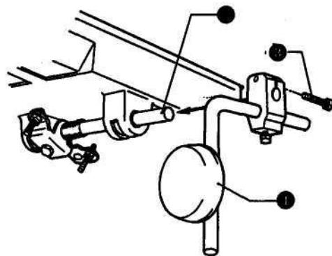
2. Отрегулировать положение коленоподъемника
