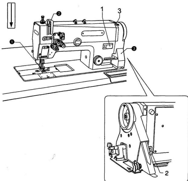
Электромагнитный подъемник прижимной лапки
