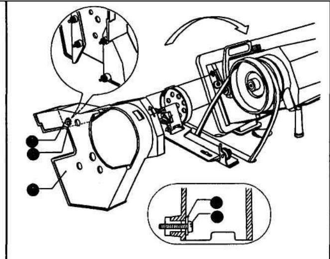
4. Затянуть четыре винта (2), присоединенных во время операции 2, описанной выше, и винт (4), для того чтобы установить крышку ремня U (1).
