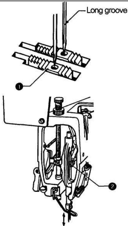
4. Проверить высоту игловодителя. Повернуть шкив машины так, чтобы переместить игловодитель в крайнее нижнее положение, и отрегулировать машину так, чтобы отметка (а) была выровнена, как показано на рисунке.
