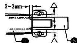
6. Установить крышку (7) на крышку ремня D (5) между крышкой ремня U (1) и крышкой ремня D (5), а затем вставить ее в канавку крышки ремня D (5).
