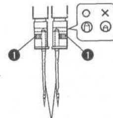
1. Повернуть шкив машины так, чтобы игловодитель в крайнее верхнее положение.
