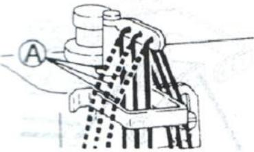
Пунктирными линиями (A) обозначена эластичная нить. Сплошной линией обозначена стандартная нить.
